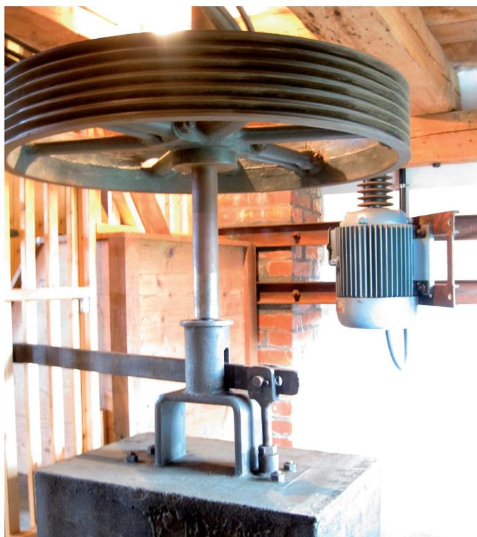
und zusammen mit Otmar den Mühlsteinantrieb mit 6 Keilriemen mit dem Motor verbunden. Am 3. März 2017 war es nun soweit. Ein historischer Moment. Otmar schaltete den Motor vom Schrotwerk ein, und das Rüttelwerk am Mühlentrichter erfüllte die Mühle mit seinem lauten Klipp Klipp Klapp, Klipp Klipp Klapp. Ein Geräusch welches in der Mühle seit 1999
